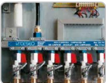
Collecteurs de distribution intégrés à panneaux pneumatiques de contrôle pour automatisation.
