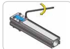
4.3. **Serrage des vis** : Effectuer cette opération avec un soin particulier. Éviter de serrer excessivement les vis afin de ne pas endommager le filet. Le couple de serrage des vis M6 est compris entre un min. de 10 N.m (91 in.Lbs) et un maximum de 13,5 N.m (120 in.Lbs).
