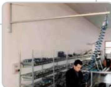
Bras pivotants en aluminium anodisé montés sur banc de travail pour le support des outils pneumatiques.
