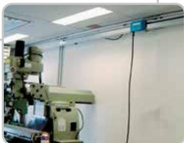
Bras pivotants en aluminium anodisé à rayon de manœuvre élevé pour l'alimentation des outils pneumatiques.
