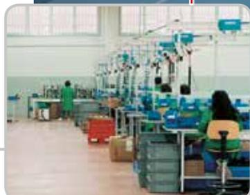
Bancs de travail équipés de chariot mobiles sur rail pour la distribution d'air comprimé et d'électricité.
