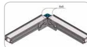
4.5. **Coulissement de la ligne** : En cas d'installation rectiligne supérieure à 50 m, prévoir un joint de recouvrement tous les 30 - 40 m. Cette précaution facilitera l'éventuel démontage des barres. Monter les deux plaques latérales au milieu de l'espace ménagé.
