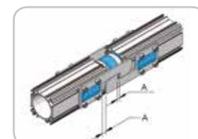
4.6. **ATTENTION** : après avoir installé les raccords, serrer les vis sans forcer sous peine d'endommagement des filets.
