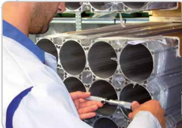
Nous effectuons le contrôle qualité du matériel selon le cahier des charges d'échantillonnage prescrit par la norme UNI ISO 2859. Une fiche de contrôle est prévue pour chaque composant et indique les contrôles devant être effectués. Selon la « criticité » du composant et la taille du lot, un facteur de contrôle LQA est sélectionné (limite de qualité admise) entre 1.5, 2.5 et 6.5.
