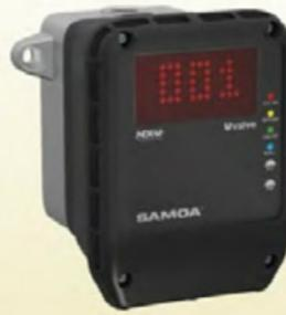
Zusammengefasst in einer kompakten Einheit beinhaltet es einen Ovalrad-Impulsgeber mit hoher Genauigkeit, ein Einzel- oder Doppel-Magnetventil (je nach Ausführung), ein Leitungssieb und ein Elektronik-Modul für die Kommunikation mit den weiteren Systemkomponenten. Zudem ist ein großes, gut ablesbares LED-Display zur Kontrolle integriert, welches die Zapfstellenummer anzeigt und zusätzlich vier farbige LEDs, welche den aktuellen Betriebszustand des U-valves anzeigen.
