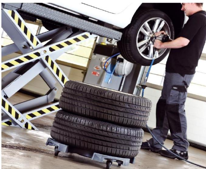
**FR** Une unité de transport astucieuse pour roues et pneus de taille. Le chariot est conçu pour 8 pneus ou 4 roues complètes. Le chariot à roue est compatible avec plusieurs types d'équipement de levage pouvant être utilisé.
