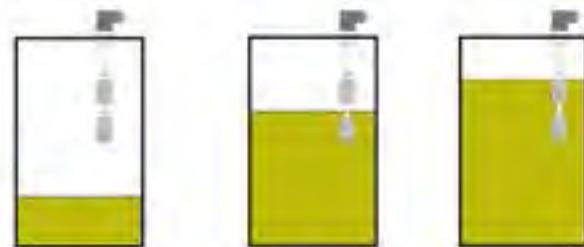
Asta a doppio livello per controllo livello fluido in cisterna. Lunghezza asta (L). Contatto basso NC (con Olio) a L<sub>2</sub> da flangia, contatto alto NO (con Olio) a L<sub>1</sub> da flangia . Gallengiante Ø 22 - Flangia filettata (G). Ulteriori configurazioni e versioni ATEX su richiesta.
